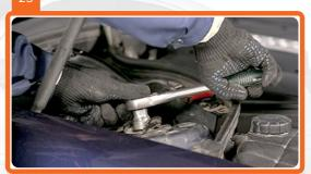
Tighten the shock strut top mount.
