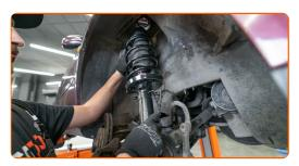
Tighten the shock strut top mount.
