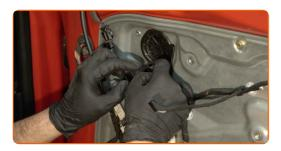
Attach the door lock actuator cable.
