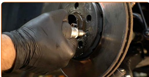
**17** Remove the brake disc.
