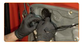
Attach the door lock actuator cable.
