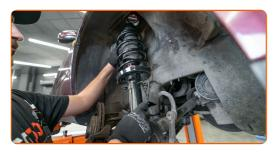
Tighten the shock strut top mount.
