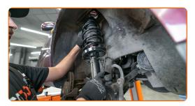
Tighten the shock strut top mount.
