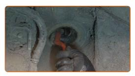
17 Install a new top shock strut mount.
