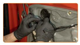
Attach the door lock actuator cable.
