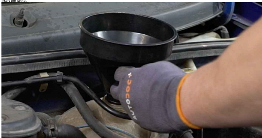
35 Pour coolant in the coolant reservoir.
