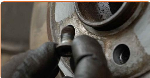
**21** Remove the brake disc.
