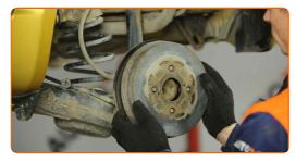
Replacement: brake drum – TOYOTA COROLLA (ZZE12\_, NDE12\_, ZDE12\_). Tip:
