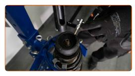
Remove the shock strut mount.
