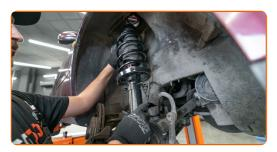
Tighten the shock strut top mount.
