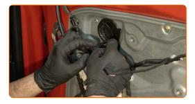
Attach the door lock actuator cable.
