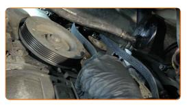
Replacement: serpentine belt – PEUGEOT EXPERT Box (VF3A\_, VF3U\_, VF3X\_).
