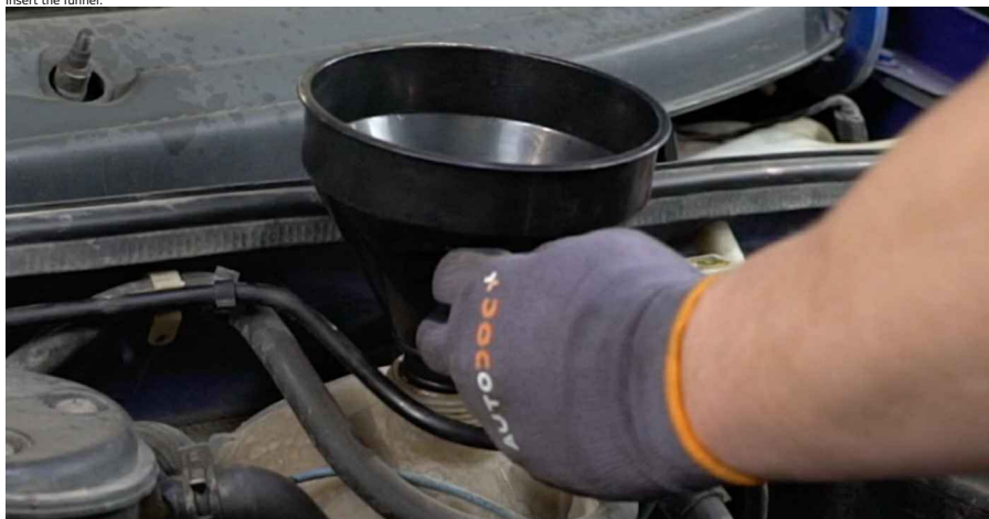
35 Pour coolant in the coolant reservoir.
