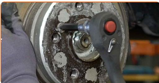
**19** Remove the fastening bolt.
