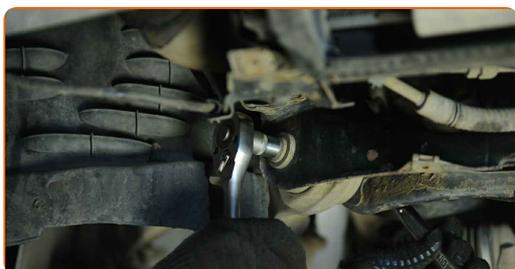
**11** Remove the fastening bolt.
