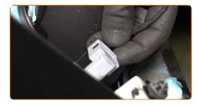
48 Attach the door lock actuator cable.
