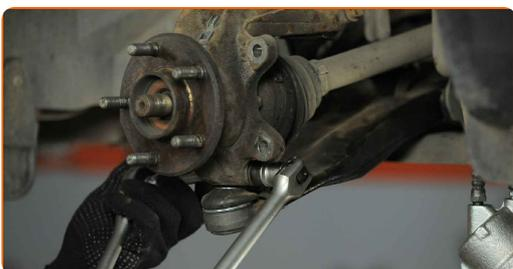
**26** Remove the fastening bolt.
