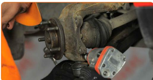
**59** Install the brake disc.
