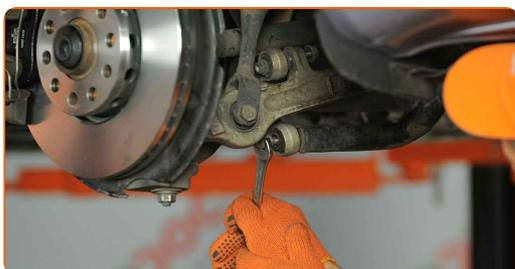
**16** Remove the fastening bolt.
