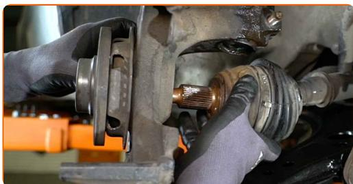
**31** Remove the fastening bolt.
