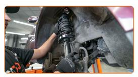
Tighten the shock strut top mount.
