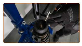
Remove the shock strut mount.
