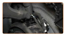
Attach the door lock actuator cable.
