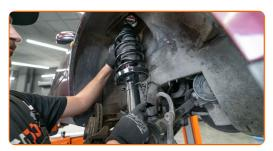
Tighten the shock strut top mount.
