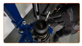
Remove the shock strut mount.
